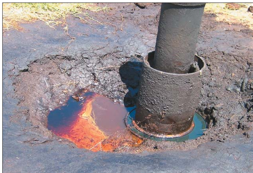
Отверстие в обсадной трубе скважины, из которого выделяется нефть. Рядом вырыт котлован и ведется несанкционированная добыча для нужд населения. Когда накопитель переполняется, нефть по отводной канаве сбрасывается в оз.Тобечик.
